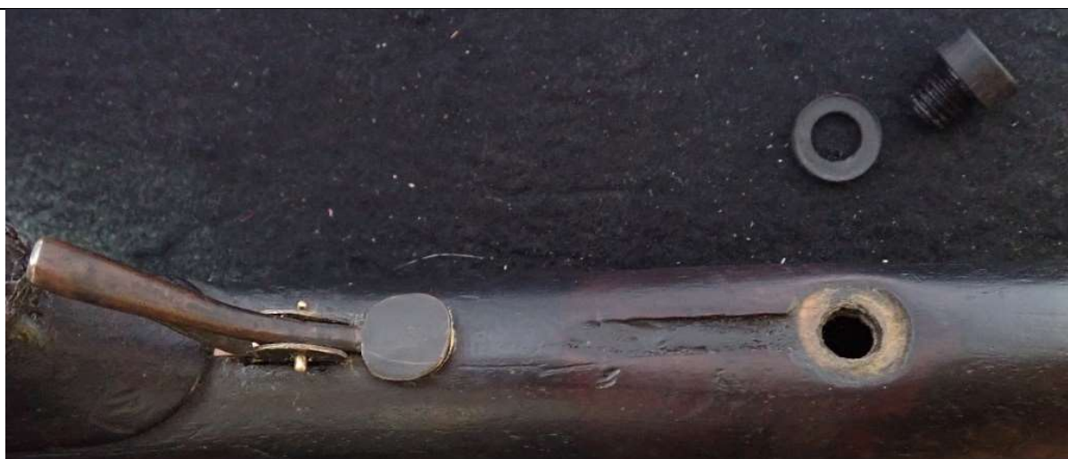
Verschliessen der beiden klappenlosen Tonlöcher mittels Gewindezapfen und Dichtung
