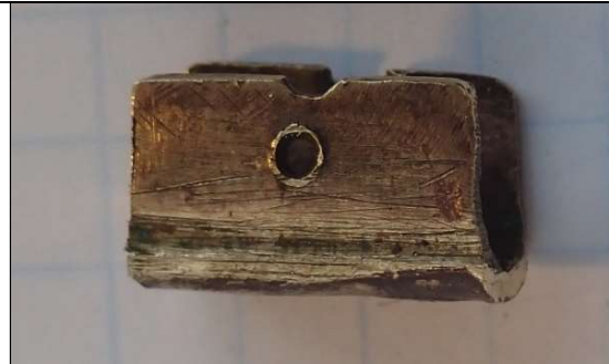
Abb. 12 Kapsel als Hebel- und Klappenlager
