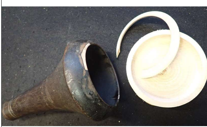
Neues Holz im Becherrand einsetzen
