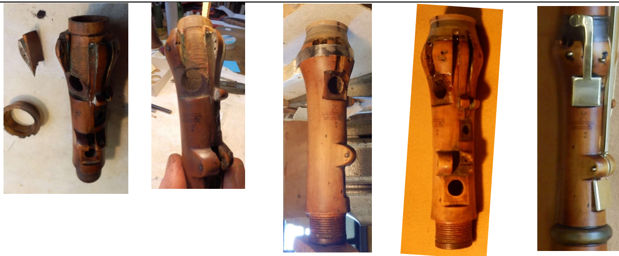
Alte Reparatur wird sichtbar und die ausgebrochenen Stücke werden mit der Zapfenherzverlängerung verleimt
