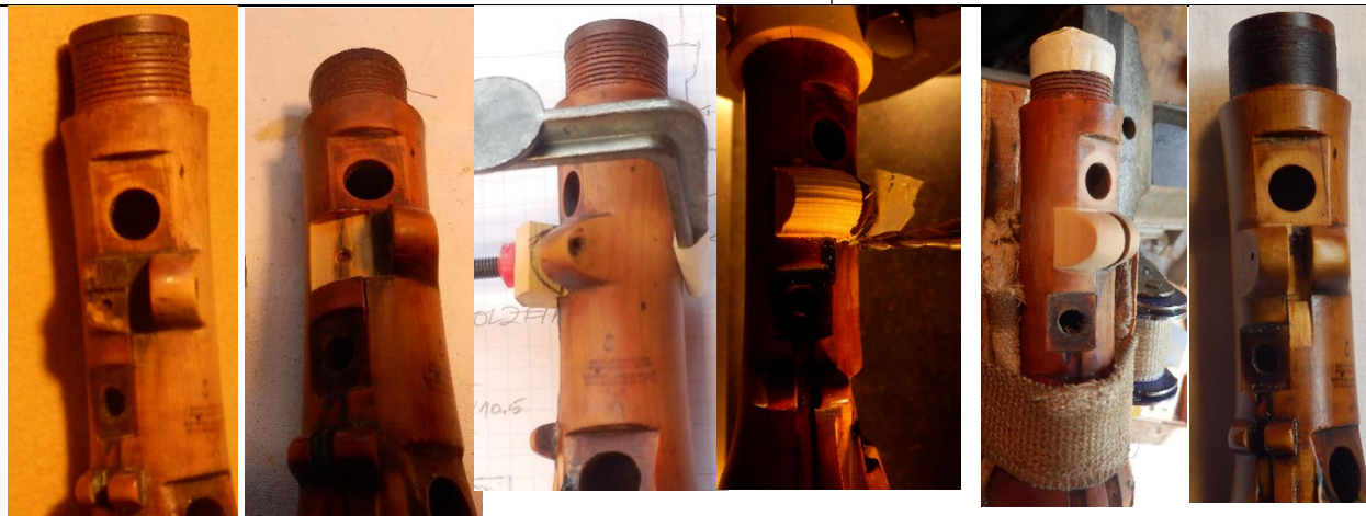
Ausgebrochener Klappenbock ersetzen/ Gerade feilen der Klappenpolsterauflagen
